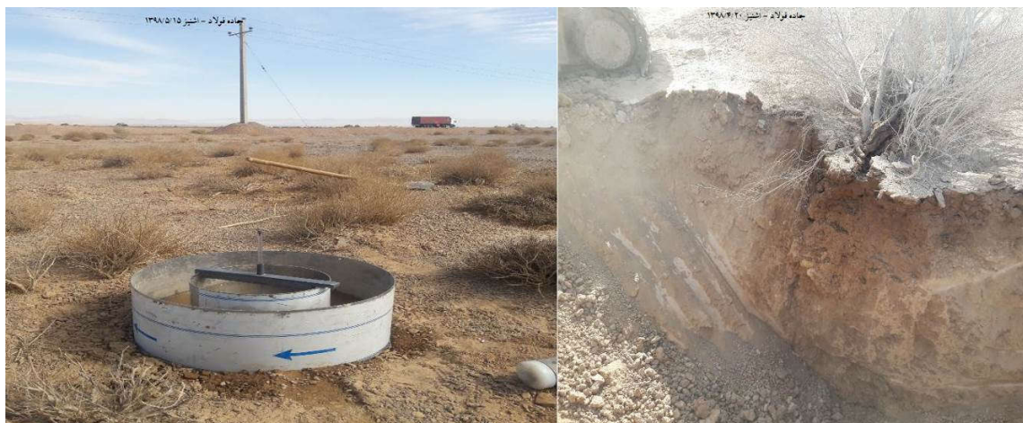
شکل (۳): تصاویر اندازه‌گیری نفوذپذیری خاک و حفر پروفیل و اندازه‌گیری عمق ریپینگ
