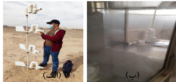
شکل (۸): (الف) قرار دادن تله های رسوب گیر در داخل تونل باد، (ب) تله های رسوب گیر سیفونی نسل ۳ مجهز به پایه و سکان چرخنده در جهات مختلف Figure (8): (a) Placing sediment traps inside the wind tunnel, (b) Generation 3 siphon sediment traps equipped with a base and a rudder rotating in different directions
