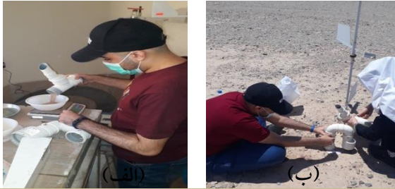
شکل (۹): (الف) تخلیه رسوبات جمع آوری شده توسط تله های رسوب گیر در ایستگاه، (ب) توزین نمونه های رسوب جمع شده در تله های رسوب گیر با دقت ۰/۱ گرم Figure (9): (a) Discharge of sediments collected by sediment traps at the station, (b) Weighing sediment samples collected in sediment traps with an accuracy of 0.1 g.
