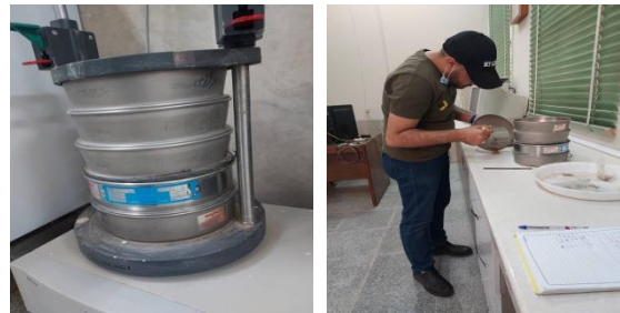
شکل (۷): دستگاه الک و شیکر و فرایند دانه بندی و توزین ذرات رسوب بادی Figure (7): Sieve and shaker device and the process of granulating and weighing wind-sediment particles
