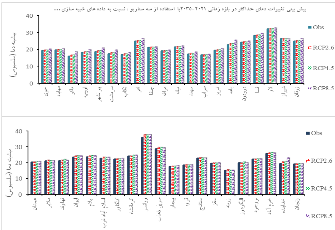
شکل (۶): مقادیر مشاهداتی و شبیه سازی شده دما حداکثر به صورت سالانه توسط مدل SDSM و تحت سه سناریو RCP2.6، RCP4.5 و RCP8.5 در بازه زمانی ۲۰۲۱-۲۰۳۵
