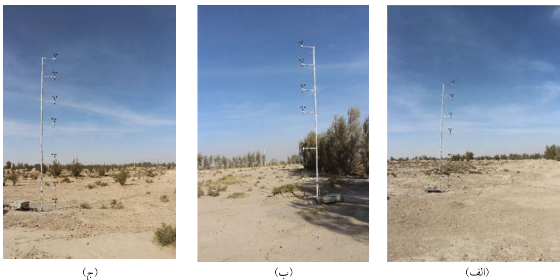
شکل (۲): نصب بادسنجها در ارتفاعات مختلف و در بالادست بادشکن (الف)، داخل بادشکن (ب) و پایین دست بادشکن (ج) Figure (2): Set up anemometers at different heights upwind of the windbreak (a), within the windbreak (b) and downwind of the windbreak (c)
