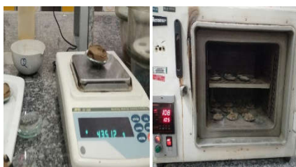
شکل (۱): مراحل انجام اندازه گیری مقاومت برشی و رطوبت Figure (1): Steps for measuring shear strength and moisture
