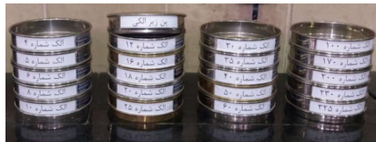
الف) الک های استاندارد مورد استفاده در آزمایشگاه برای عملیات دانه بندی A) standard sieve used in the laboratory for sieving operations
