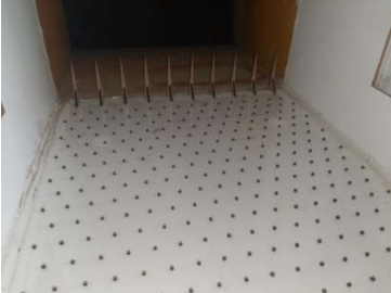
ب) نمایی از المان‌های زبری نصب‌شده داخل تونل باد B) A view of the rough elements mounted in the wind tunnel
