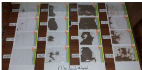
ب) نمونه های الک شده ۱ از ذرات در داخل کیسه پلاستیکی B) graded sample of particles in a plastic bag
