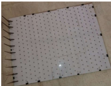
الف) صفحه آماده‌شده هرمی‌ها و المان‌های زبری A) Prepared plate of pyramids and rough elements
