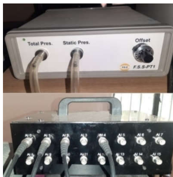
(ب) تجهیزات کامپیوتری شامل فشارسنج الکترونی و دیتالاگر (A/D) B) Computer equipment including electronic barometer and (A / D)
