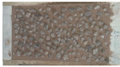
پ) سینی نمونه با پوشش سنگریزه ۵۰٪ C) the sample tray with gravel cover 50%
