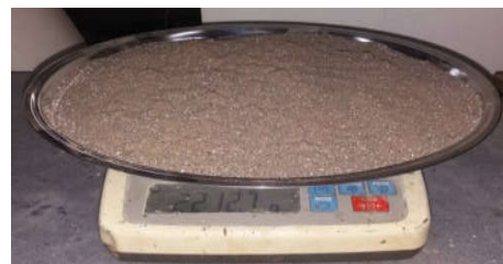
الف) نمونه خشک شده داخل گرم کن در حال توزین بر روی ترازوی دیجیتال A) dried sample inside the oven weighing on digital scale
