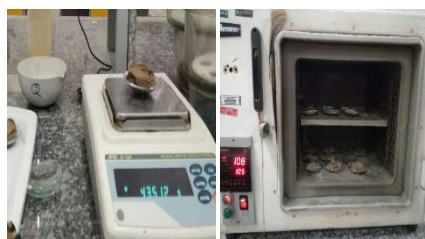
شکل (۱): مراحل انجام اندازه گیری مقاومت برشی و رطوبت Figure (1): Steps for measuring shear strength and moisture
