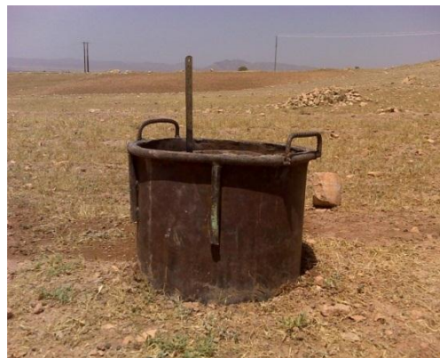
شکل (۲): استوانه‌های مضاعف نصب‌شده در محل تحقیق
