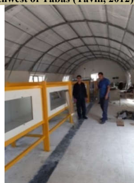
شکل (۳): نمای از دستگاه تونل باد محیط‌زیست و تجهیزات اندازه‌گیری مورد استفاده در آن
