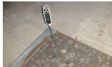
الف) اندازه‌گیری دمای سینی نمونه ذرات شن و ماسه به کمک دماسنج
