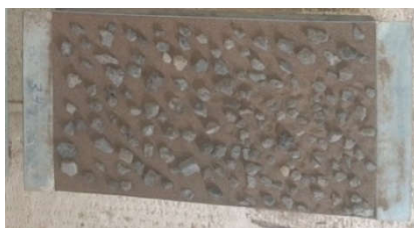
ب) سینی نمونه با پوشش سنگریزه ۳۰٪
