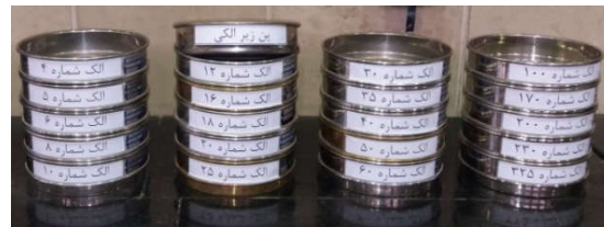
الف) الک های استاندارد مورد استفاده در آزمایشگاه برای عملیات دانه بندی A) standard sieve used in the laboratory for sieving operations
