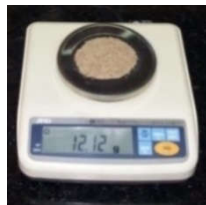
ب) ترازوی دیجیتال با دقت ۰/۰۱ گرم برای توزین ذرات B) weighing scale with accuracy of 0/01 g for weighing particles
