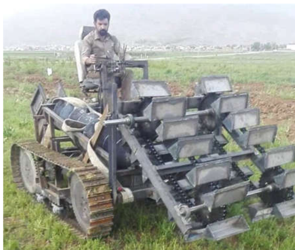
شکل (۲): نمایی از بخش محرک دستگاه بادشکن خاکی Figure (2): View of the driver section of the ridger device
