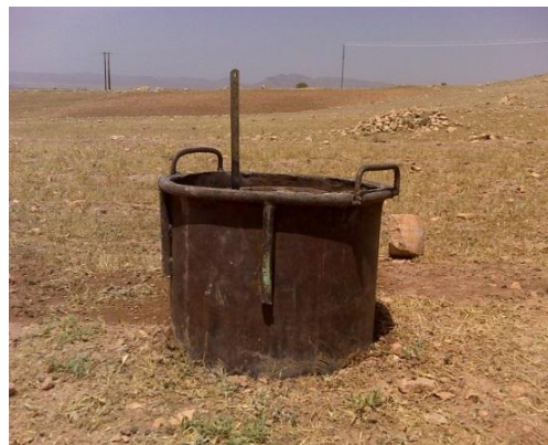
شکل (۲): استوانه‌های مضاعف نصب‌شده در محل تحقیق
