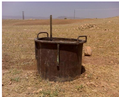
شکل (۲): استوانه‌های مضاعف نصب‌شده در محل تحقیق
